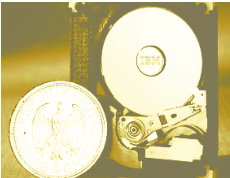
Das Microdrive von IBM. Die eigentliche Festplatte hat ungefähr den Durchmesser eines Markstücks.
